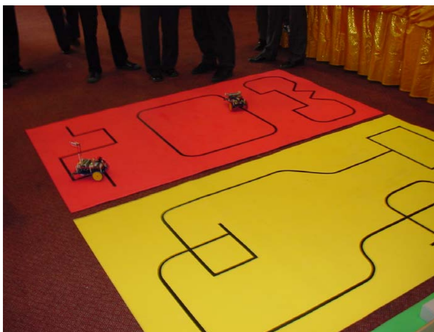
รูปแสดงตัวอย่างสนามสำหรับทดสอบหุ่นยนต์เดินตามเส้น
