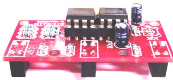
รูปแสดง ลักษณะของแผงวงจรสำหรับตรวจจับเส้น (R-TRACKER3 BOARD)
