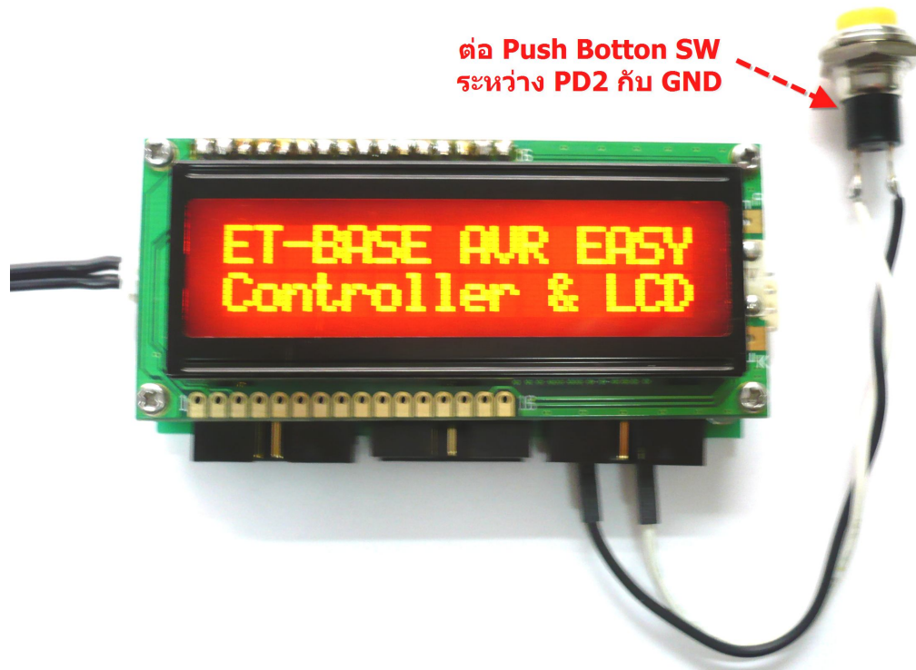
รูปแสดง การต่อสวิตช์ สำหรับใช้ทำงานกับ Boot Loader
