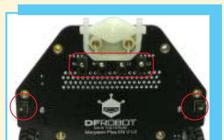
Infrared Sensor Tracker (ตรวจจับเส้น) 6 จุด
