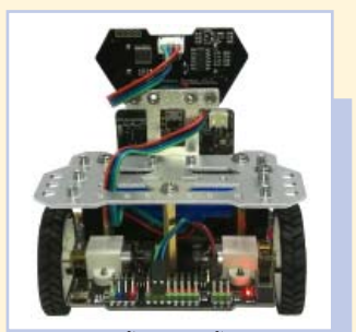
โครงโลหะพร้อมจุดยึดด้านบนของ ROBOT ใช้ในการต่อเพิ่มขยายการทำงาน
