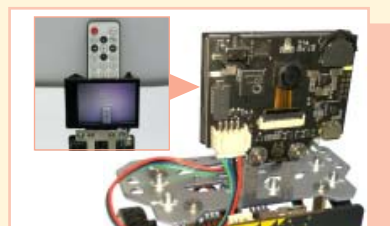
สามารถต่อเพิ่มบอร์ด HUSKY LENS เป็นกล้อง และจอแสดงภาพในระบบ AI ได้
