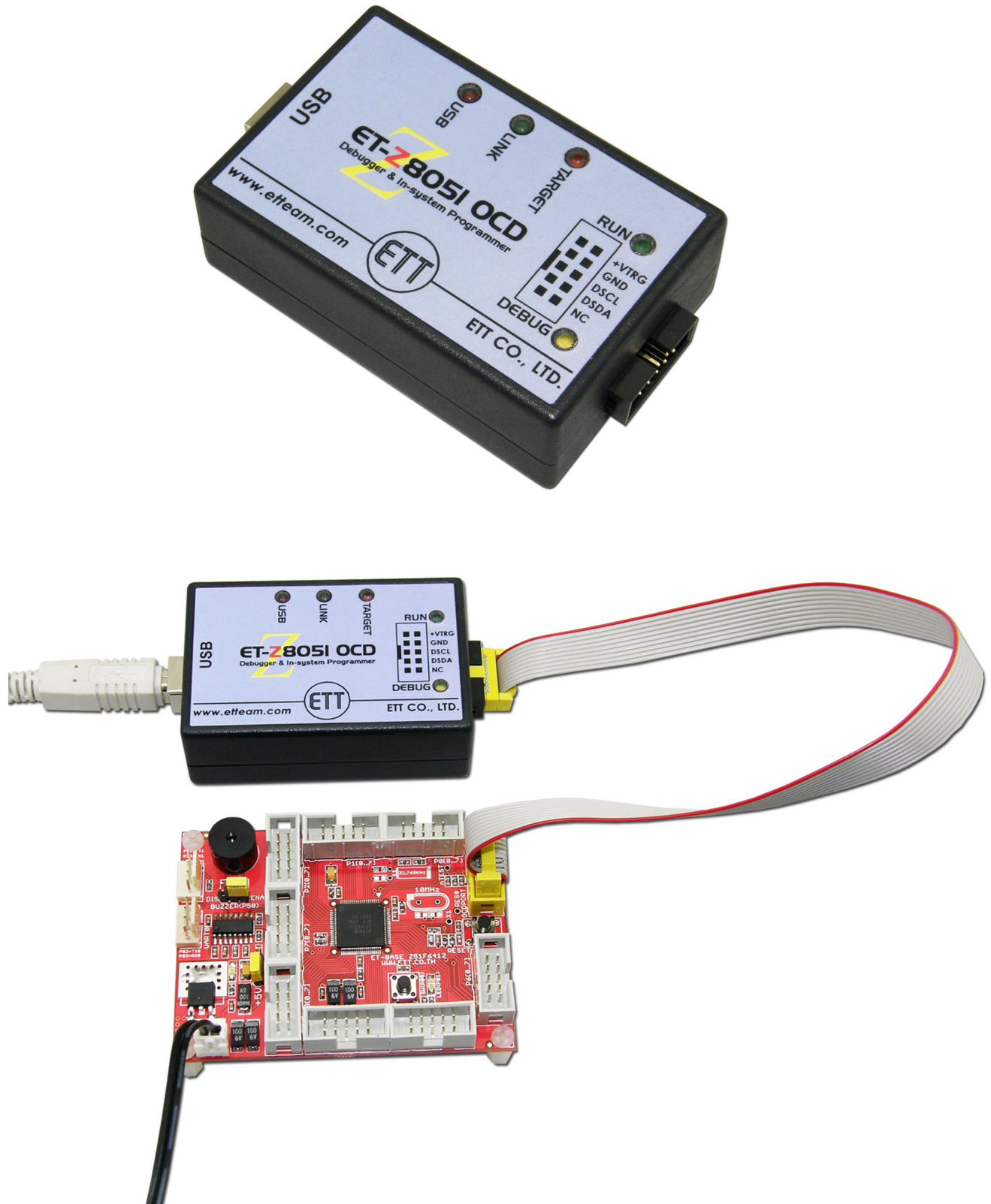
รูปแสดงการเชื่อมต่อ ET-BASE Z51F6412 กับ ET-Z8051 OCD
