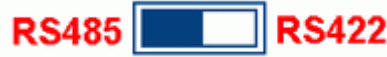
รูปแสดง การเลือกสวิตช์ระหว่าง RS422 กับ RS485
