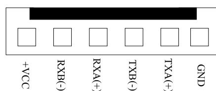
แสดงหัวต่อสัญญาณ RS422/485 ของบอร์ด CP-JR08GP32 V2.0 เมื่อเลือกเป็น RS422
