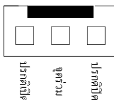
รูปแสดง ลักษณะขั้วต่อสัญญาณจากหน้าสัมผัสของ RELAY
