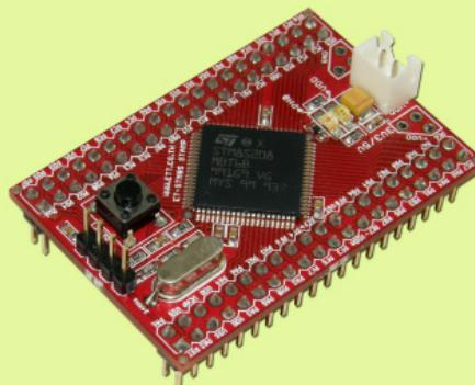
บอร์ดในตระกูล STM8 ออกแบบโครงสร้างเป็นบอร์ดขนาดเล็ก ง่ายต่อการนำไปประยุกต์ต่อใช้งาน หรือต่อเข้ากับบอร์ด I/O ต่างๆ
