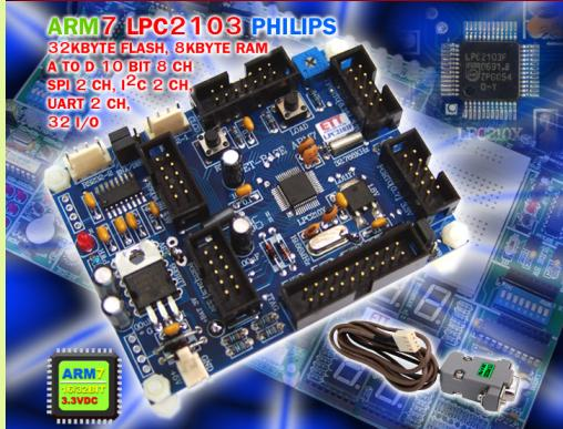
บอร์ดตระกูล ARM7 ซึ่งเป็น MICROCONTROLLER ที่สามารถ RUN ได้ทั้งแบบ 16 BIT และ 32 BIT ออกแบบ เป็นบอร์ดขนาดเล็ก มาตรฐานขนาดบอร์ด ET-BASE ใช้งานได้ลิสท์ หรือจะใช้กับชุดทดลอง ET-BASIC I/O V1 ในการอ่านทดลองต่างๆ ก็ได้
