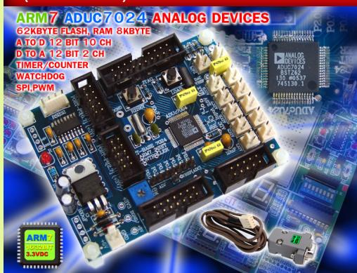
บอร์ด ARM7 MCU เบอร์ ADUC7024 ของบริษัท ANALOG DEVICE โดยมี จุดเด่นคือ มี A TO D 12 BIT 10 CH และ D TO A 12 BIT 2 CH ... ออกแบบบอร์ดขนาดมาตรฐาน ET-BASE สามารถนำไปใช้งานอิสระ หรือต่อทดลองกับบอร์ด ET-BASIC I/O V1 ก็ได้
