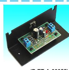
**ET-POWER 5**MODEL : **ET-POWER 5** + 5VDC / 1A
