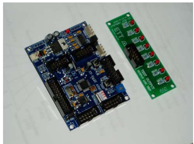
รูปที่ 1 (ซ้าย) ET-USB/RS232 (ขวา) ET-Base ARM7 LPC2103 และ ET-TEST 10P/OUT
